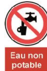
Figure 12 : Plaque de signalisation « eau non potable »
